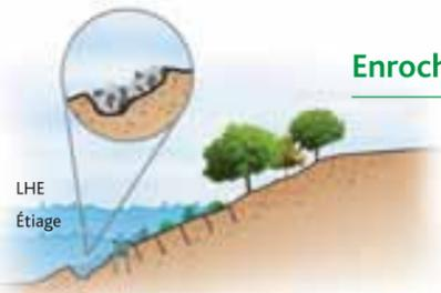
L'enrochement est une structure de pierre déposée dans la rive. Cette technique doit être utilisée dans les cas d'érosion sévère ou quand la zone érodée est soumise à des vagues ou de l'érosion fluviale. Le calibre des pierres dépendra de la force de l'érosion. L'aménagement d'une clé au bas de l'enrochement est nécessaire pour assurer sa stabilité. L'enrochement peut être utilisé en combinaison avec une autre méthode.
