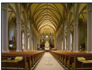
« **arcade** » : succession d'arcs. Elle peut être utilisée pour séparer les vaisseaux du corps principal d'un lieu de culte ou pour marquer des espaces de circulation à l'intérieur ou à l'extérieur d'un bâtiment.
