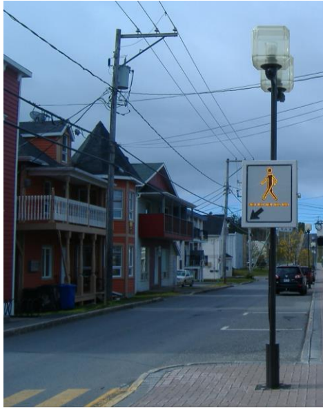
Indication des traverses piétonnières : panneaux à LED
