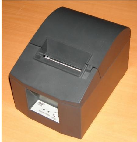
2. Ouvrir l'imprimante en appuyant sur le bouton à droite de celle-ci et en le ramenant vers vous. Le couvercle sera alors déverrouillé et il sera possible de l'ouvrir.
