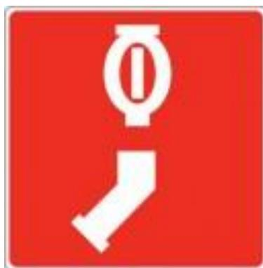
**5)** Le pictogramme, illustré au croquis n° 2 du présent article, intitulé « Système de gicleurs automatiques prise double », indique la présence d'un raccord-pompier à prise double qui alimente un système de gicleurs automatiques. Ce pictogramme doit être installé sur le bâtiment de manière à orienter rapidement les pompiers. Il peut être accompagné de flèches directionnelles.
