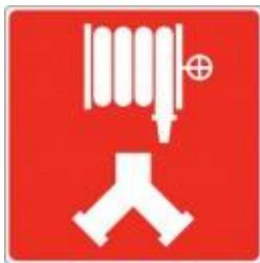
**7)** Le pictogramme, illustré au croquis n° 4 du présent article, intitulé « Système de gicleurs automatiques et canalisation incendie » indique la présence d'un raccord pompier à prise double qui alimente le système de gicleurs automatiques et les canalisations d'incendie. Ce raccord pompier est destiné au système combiné. Ce pictogramme doit être installé sur le bâtiment de manière à orienter rapidement les pompiers. Il peut être accompagné de flèches directionnelles.
