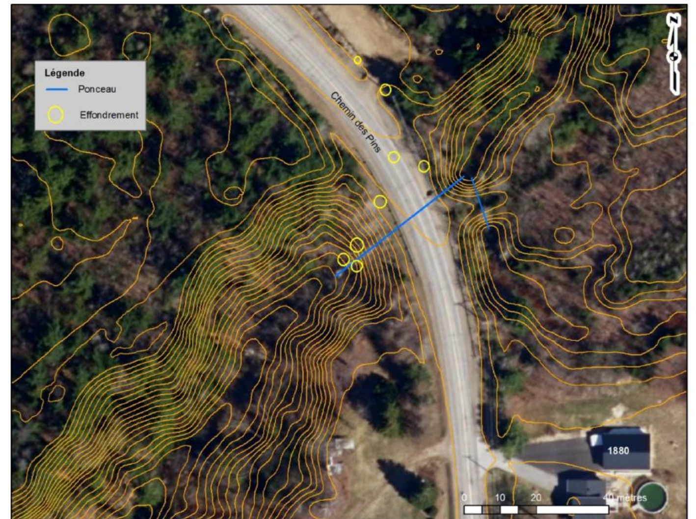
Figure 1 : Croquis de la situation indiquant l'emplacement des effondrements observés sur le terrain
