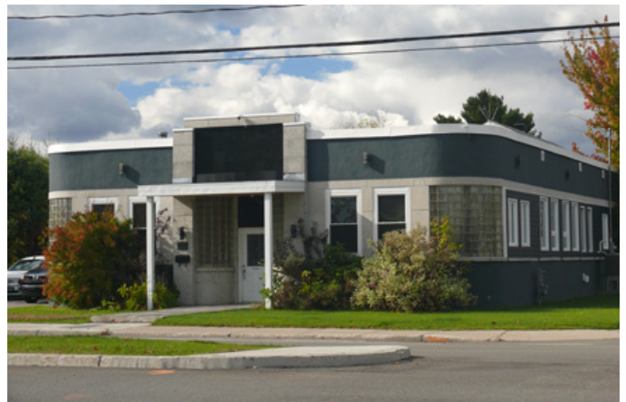
92. Ouvertures et portail en blocs de verre aux surfaces courbes de l'ancienne laiterie Madelon (105, rue Latreille).
