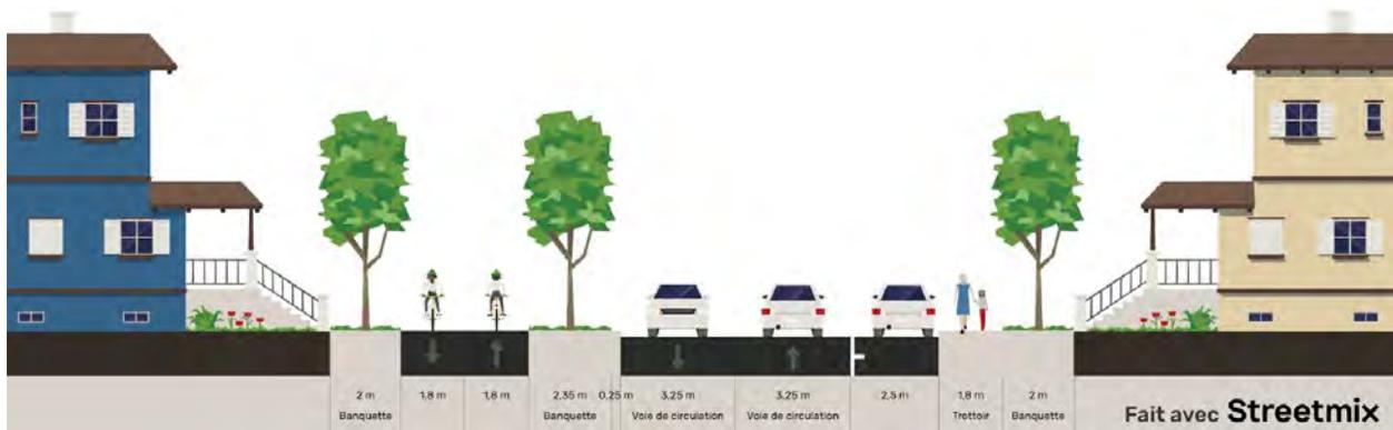
Figure 9 : Coupe LR-06 : rue avec chaussée de 9,0 m, piste multifonctionnelle et trottoir
