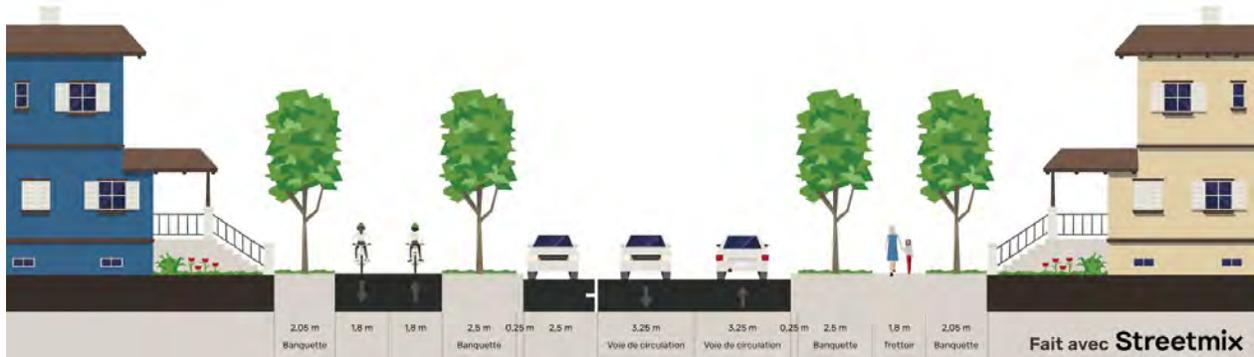
Figure 10 : Coupe LR-07 : rue avec chaussée de 9,0 m, piste multifonctionnelle, trottoir et banquettes
