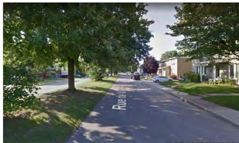
**Figure 21 : Chaussée de largeur de 6,5 m pour permettre le dépassement d'un véhicule arrêté**
