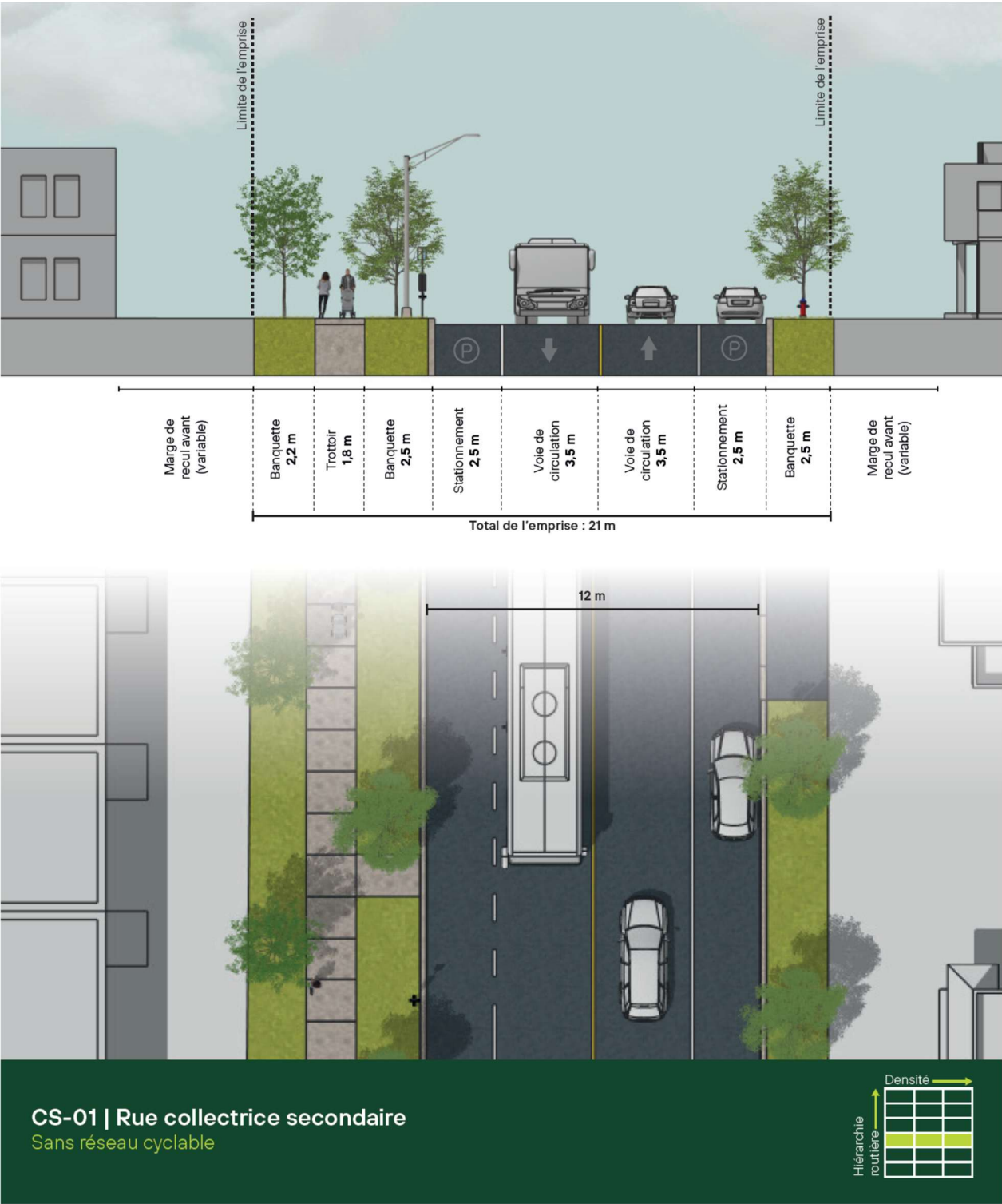
Figure 16 : Coupe CS-01 : rue collectrice secondaire
