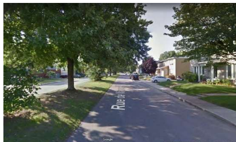
Figure 22 : Chaussée de largeur de 6,5 m pour permettre le dépassement d'un véhicule arrêté
