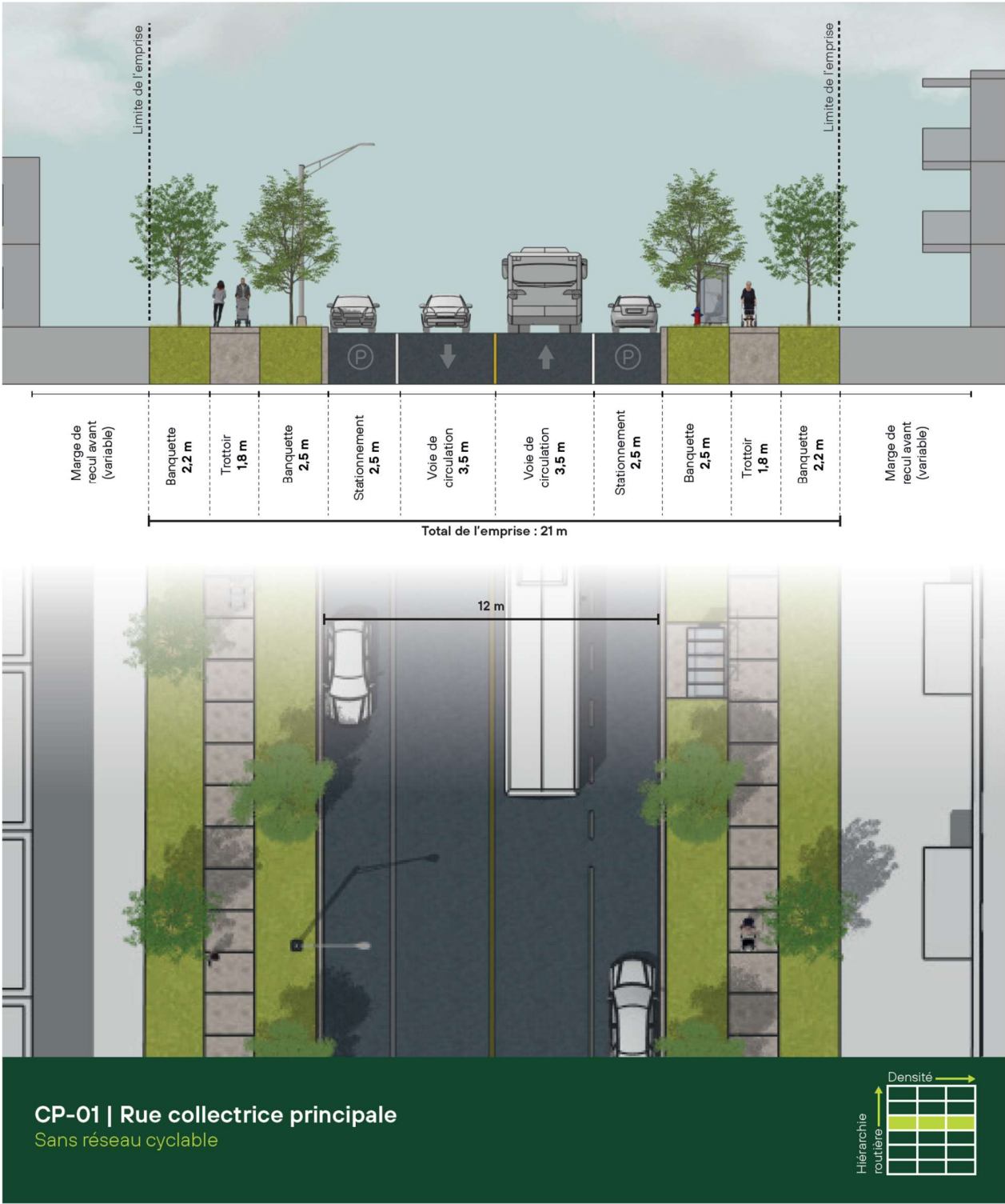
Figure 18 : Coupe CP-01 : rue collectrice principale
