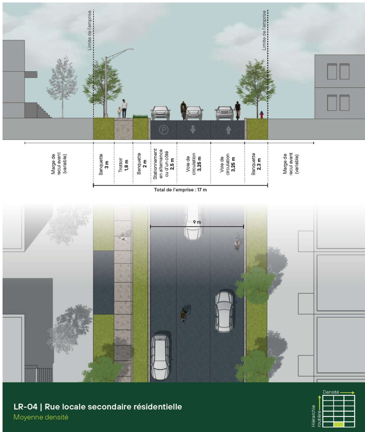
Figure 7 : Coupe LR-04 : rue avec chaussée de 9,0 m, trottoir et banquette
